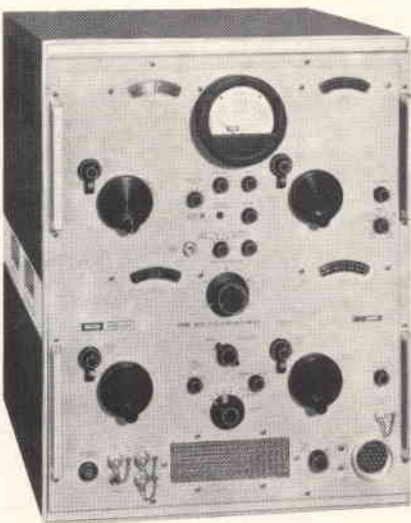
Fig. 3 - Misuratore di campo e di rumore di tipo professionale della SINGER, serie NF per misure nella gamma 1 \div 10 GHz.
