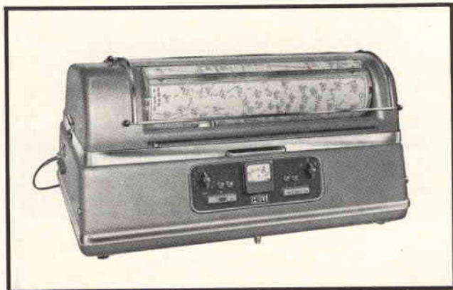
Fig. 4 - Ricevitore per fac-simile della HELL per la ricezione delle carte meteorologiche.
